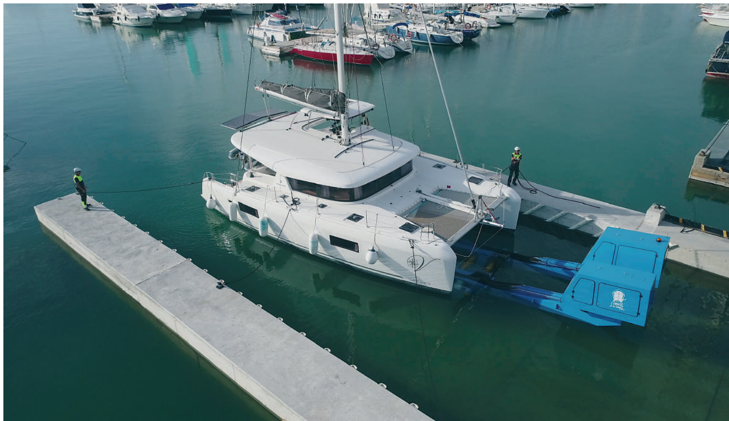
Port Ginesta dispone de un carro hidráulico anfíbio autoportante con capacidad para poner en seco catamaranes de hasta 45 toneladas.
